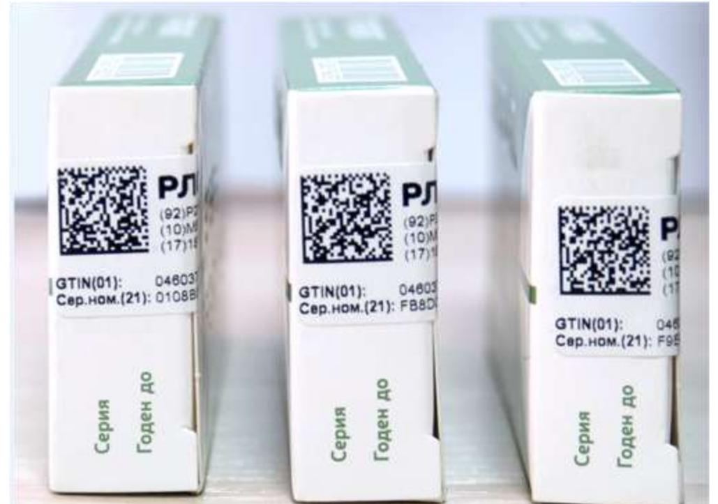
Комплекс системы «**РЛС® Прослеживаемость**» + оборудование компании **ACG** предназначен для автоматической печати DMC на вторичной упаковке.
